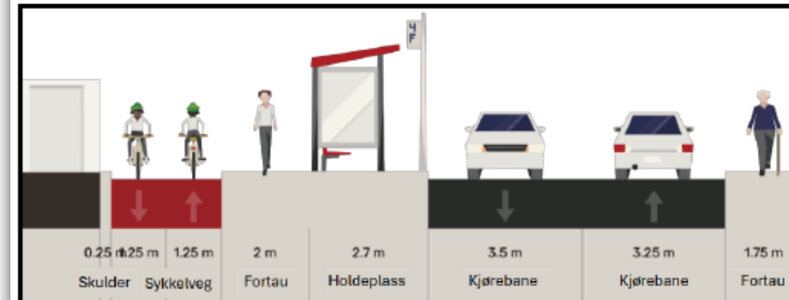
Figur 5.11: Snitt ved holdeplass i nord utenfor skolen, profil 2330. Total bredde: 15,95 m. Kilde: Streetmix Sweco.
